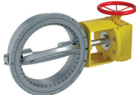
Конструкция затвора с тройным эксцентрикситетом обеспечивает равномерное распределение удельных давлений по всей уплотнительной поверхности, требуя минимального крутящего момента
