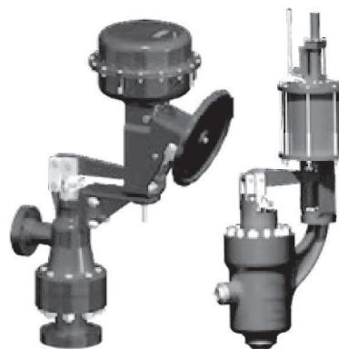
Клапаны серии 77000 с антишумовым (Lo-dB®) затвором обеспечивают регулирование сжимаемых сред высокого давления без образования эрозии, вибрации и шума, возникающих при применении регулирующих клапанов стандартной конструкции. Благодаря сравнительно большим проходным сечениям и многоступенчатому распределению перепада давления, эти клапаны особенного хорошо подходят для применения на газообразных или двухфазных газожидкостных средах, в составе которых присутствуют механические примеси.
