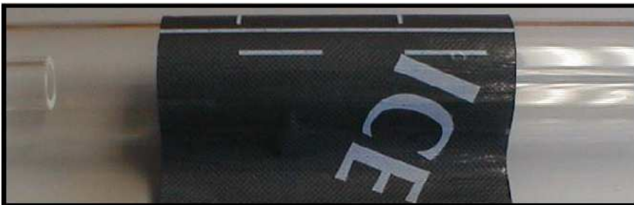
Рис. 3-23: Демпфирующий материал DMP-1, обмотанный вокруг трубы
