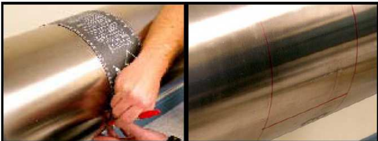
Рис. 3-14: Маркировка положения, соответствующего 3 часам
