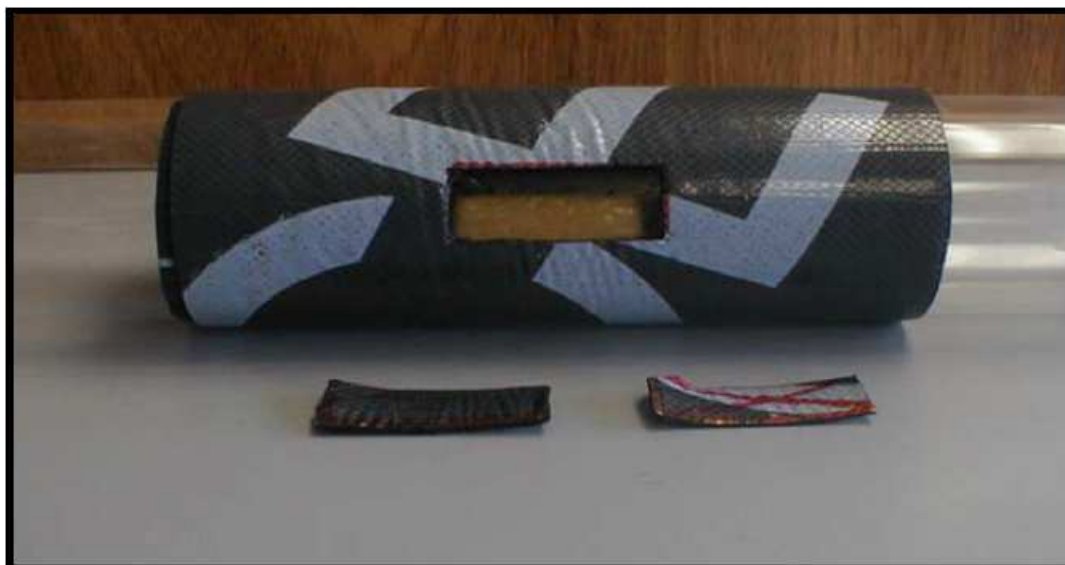
Рис. 3-25: Демпфирующий материал DMP-1 с вырезанным отверстием под ультразвуковым преобразователем
