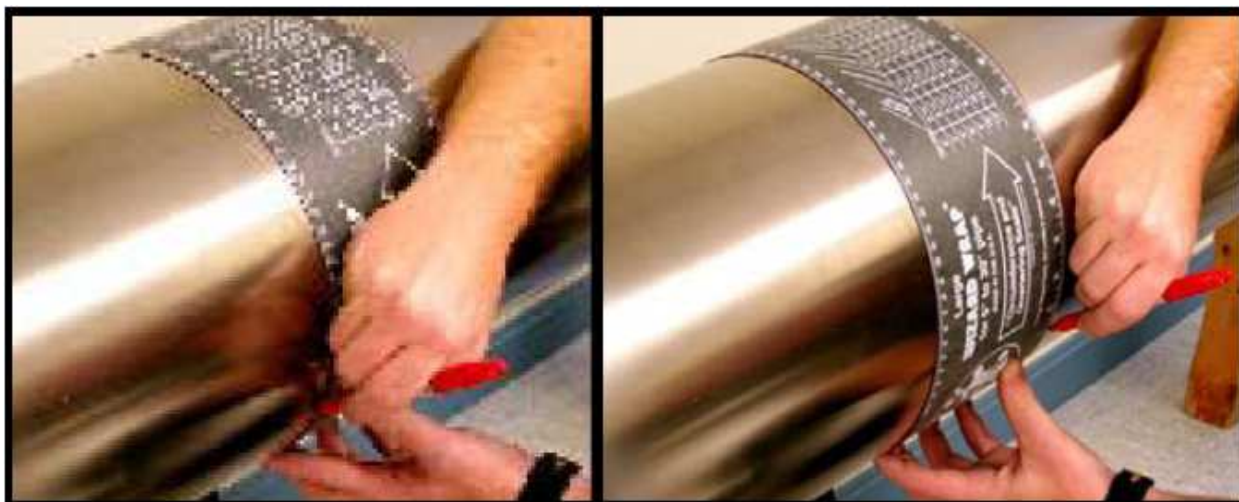
Рис. 3-13: Маркировки линий по окружности трубы
