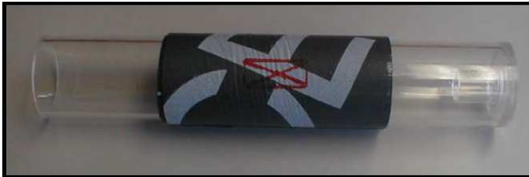
Рис. 3-24: Демпфирующий материал DMP-1 с нанесенным следом ультразвукового преобразователя трубы
