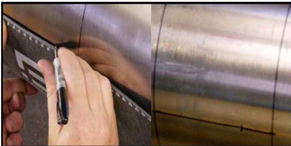
Рис. 3-15: Маркировка положения, соответствующего 9-ти часам
