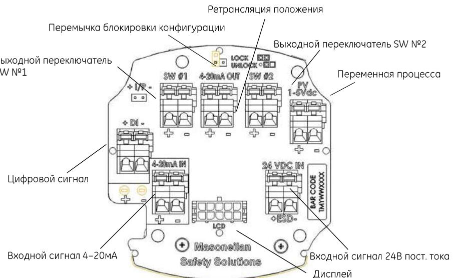
Рисунок 17 Разъемы для подключения к блоку электроники A/DSD (через клеммную панель)
