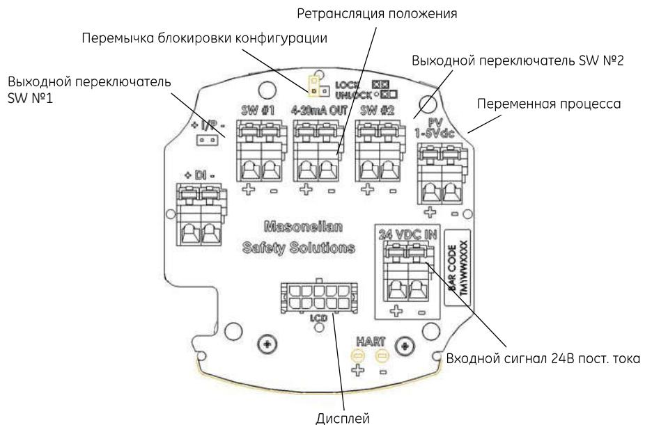
Рисунок 16 Разъемы для подключения к блоку электроники DSD (через клеммную панель)
