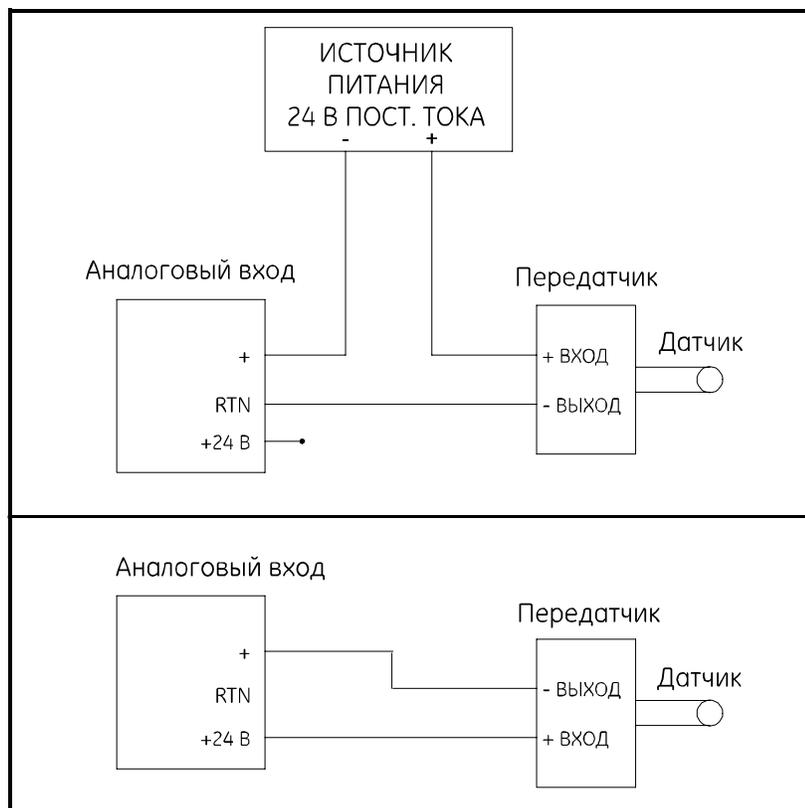
**Рис. 1-7. Электромонтажная схема аналогового входа**
