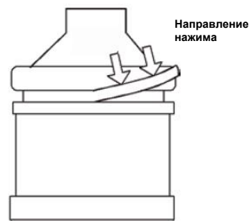
Рисунок 8 – Установка уплотнительного кольца
