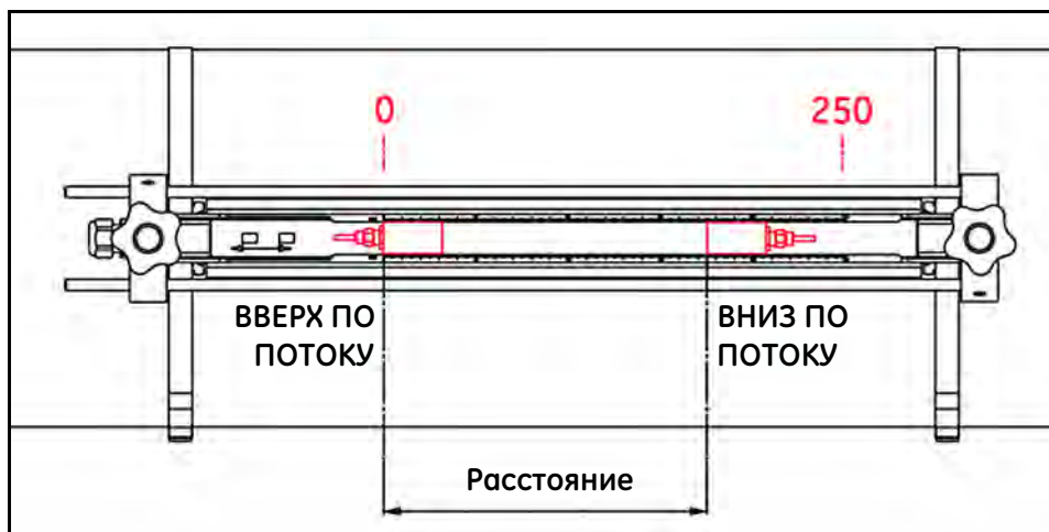
Рисунок 15: Расстояние между датчиками на двух приспособлениях
