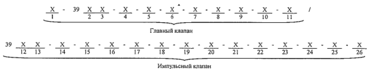
Рисунок 1 - Структура условного обозначения клапанов предохранительных
