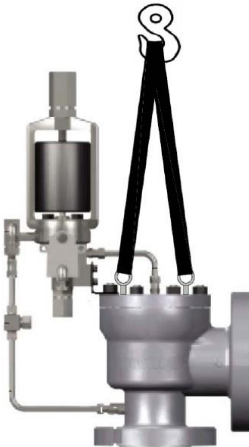
Рисунок Г.1 – Схема строповки клапанов предохранительных
