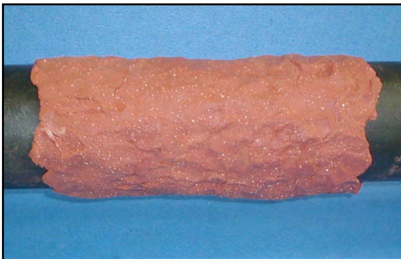
**Рис. 2-8. Распределение демпфирующего материала DMP-3**
