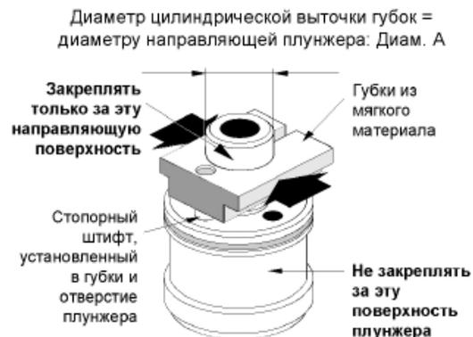
Рис. 4: Разборка узла шток-плунжер клапана
