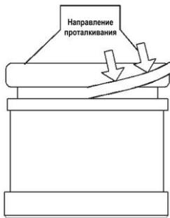
Рис. 8 – Установка уплотнительного кольца
