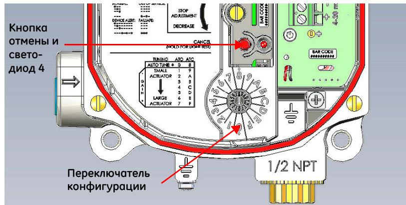
Рис. 23. Переключатель конфигурации
