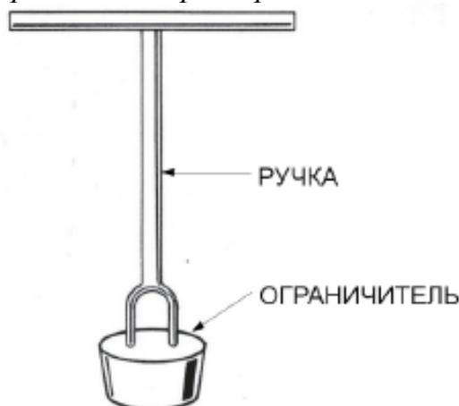
Рисунок 8 – Устройство проведения притирки
