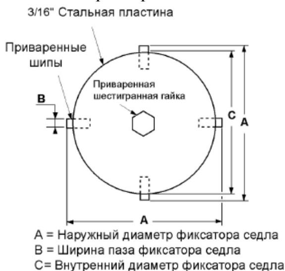
Рисунок 5 - Рекомендуемые материалы, толщина и метод конструкции
