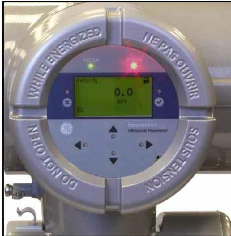
Рисунок 16: Окно в верхней части корпуса
