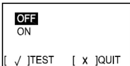
Выберите ОТКЛ (OFF) для отключения сигнала или ВКЛ (ON) для его включения. Для начала испытаний выберите ВКЛ и нажмите [□]. Для остановки испытаний нажмите [□].
