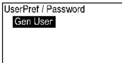
Для использования пароля обычного пользователя выберите «Обычный пользователь» (Gen User), и нажмите на клавишу [ ], появится следующий экран.
